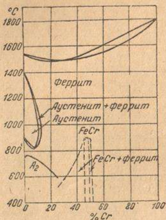
Рис. 3. Диаграмма Байна и Эборна для системы Fe—Cr.
