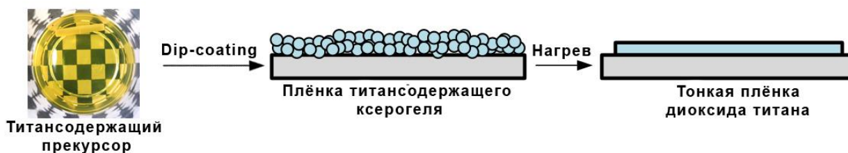
Рис. 1. Схема получения тонких плёнок диоксида титана с применением раствора гидролитически активных прекурсоров [\text{Ti}(\text{OC}_4\text{H}_9)_{4-x}(\text{C}_5\text{H}_7\text{O}_2)_x]
