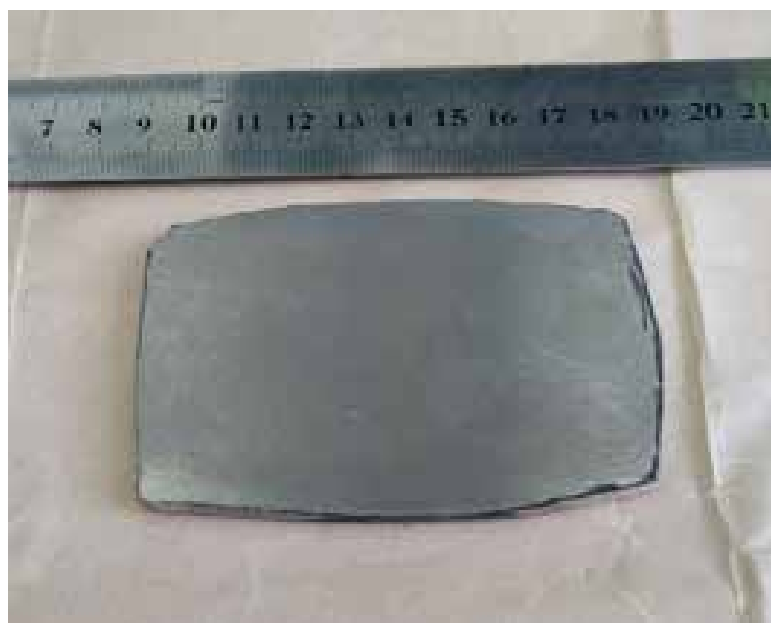
Рис. 1. Фото образцов из материала TiB-40 масс.%Ti, полученных при времени задержки 25 с с исходными размерами: а - 40x90x25 мм
