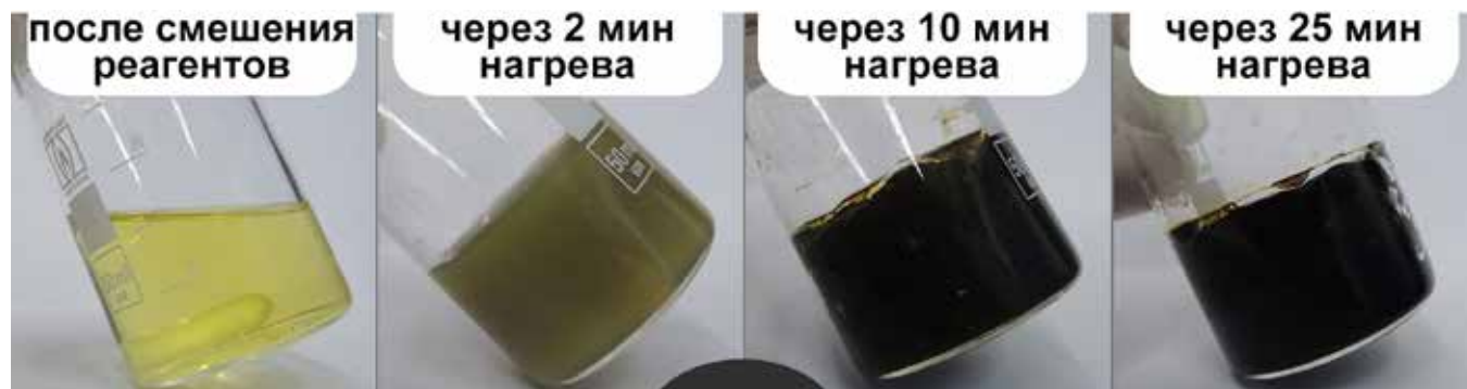
Рис. 1 Внешний вид тантал-гафний-полимерсодержащей системы в различные моменты получения геля
