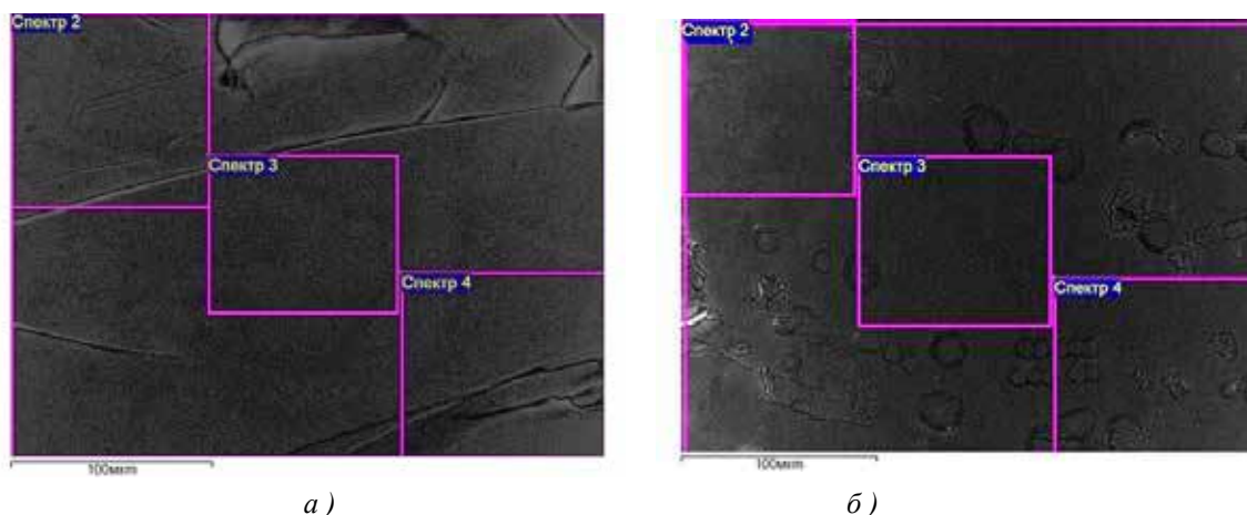
Рис. 1. СЭМ-изображения свежего скола (А) и поверхности кристалла \text{Cu}_x\text{ZrSe}_2 (Б)
