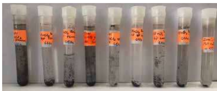
Рис. 2. Фотографии дисперсий ГО после взаимодействия с галогенами в \text{CCl}_4
