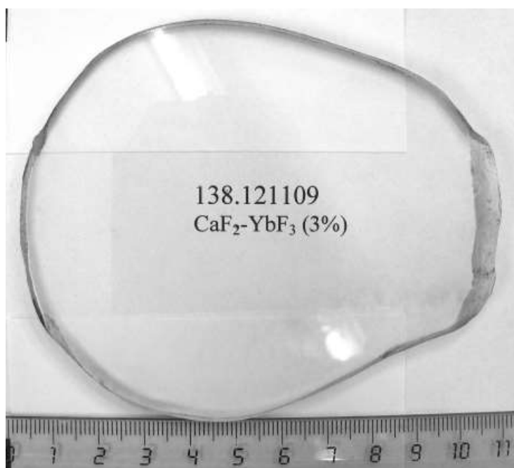
Рис. 1. Фотография керамики \text{CaF}_2:\text{Yb} (3 мол.%), полученной методом глубокой пластической деформации монокристалла.
