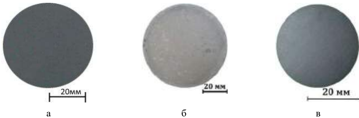
Рис. 1. Общий вид образцов из Al_{23}O_{27}N_5 : а) образец типа I, полученный по технологии реакционного спекания; б) образец типа II, полученный по технологии горячего прессования при температуре 1700^{\circ}C ; в) Образец типа II, полученный по технологии горячего прессования при температуре 1900^{\circ}C
