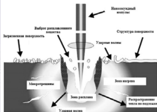
Рис. 2 – Реализация метода лазерной абляции для получения коллоидных растворов [1]
