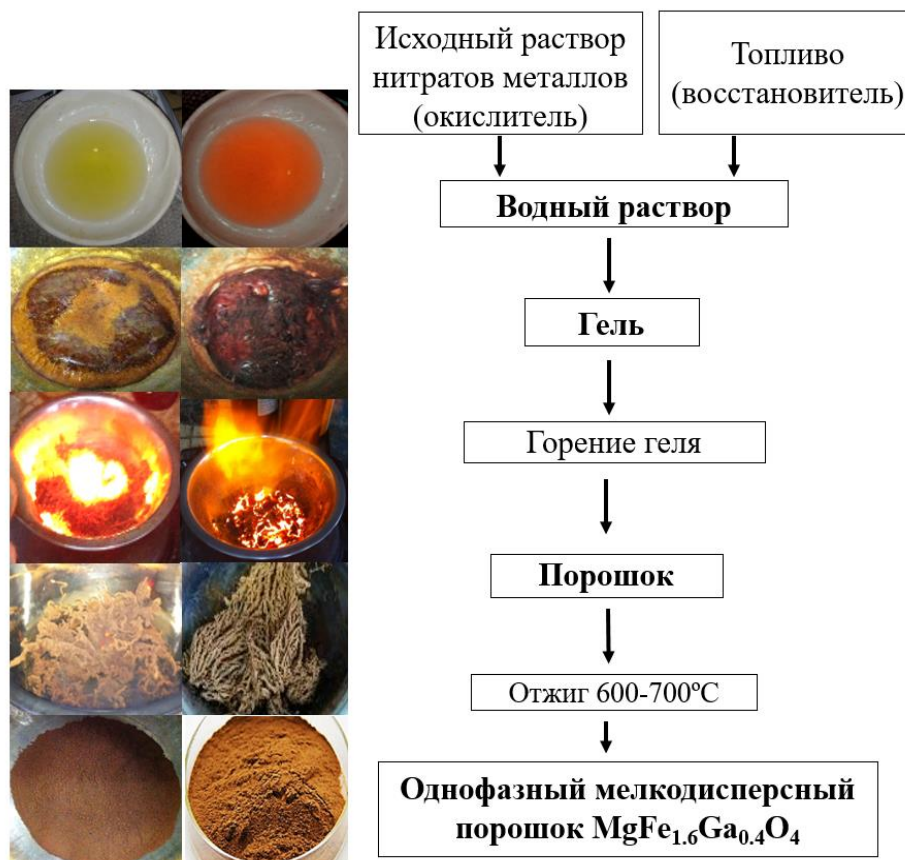
Рис. 2.1. Общая схема синтезов порошков состава MgFe_{1.6}Ga_{0.4}O_4 методом сжигания геля.
