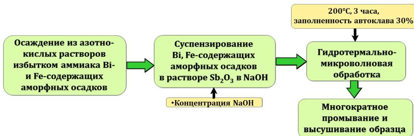
Рис. 17. Схема прободготовки в соответствии со вторым способом.
