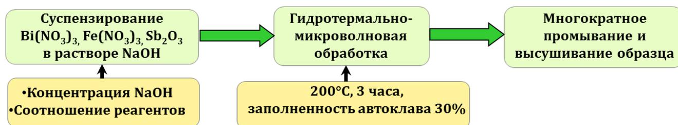
Рис. 15. Схема прободготовки в соответствии с первым способом.
