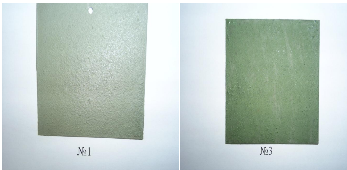
Рис.IV-6 образцы полученных защитных покрытий из габбро-базальта на поверхности ст.45
