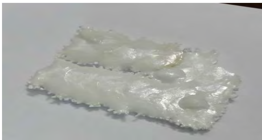
Рисунок 112 – Монокристалл лейкосапфира, полученный методом лазерного наплава из синтезированных керамических компактов
