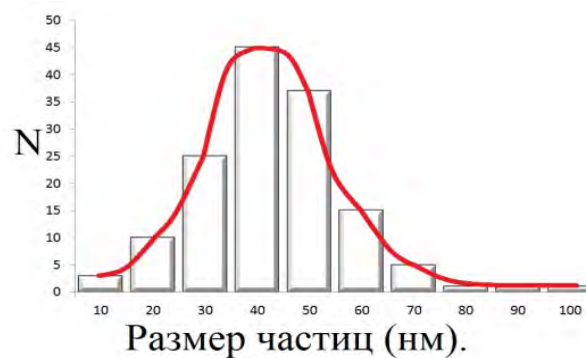
Рисунок 110 – ПЭМ – изображение и кривая распределения по размерам частиц бемита, полученного при гидротермальной обработке гидраргиллита в 1,5 масс. % растворе \text{HCl} при 200^\circ\text{C} P=1,6 МПа, \tau=24 ч
