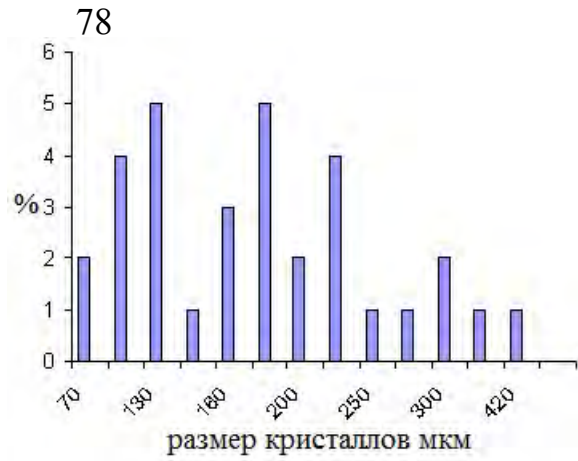
Рисунок 48 – СЭМ-изображение и распределение по размерам кристаллов корунда, полученного при гидротермальной обработке гидраргиллита марки МДГА с активатором – солью лантана при 410°C и P=27,5 МПа в течение 24 ч [118]
