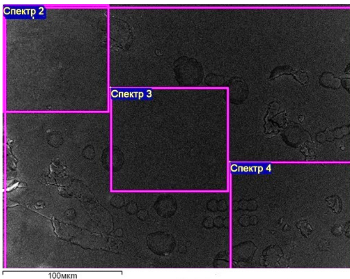
Рис. 40. СЭМ-изображение поверхности кристалла \text{Cu}_x\text{ZrSe}_2 после извлечения из ростовой ампулы
