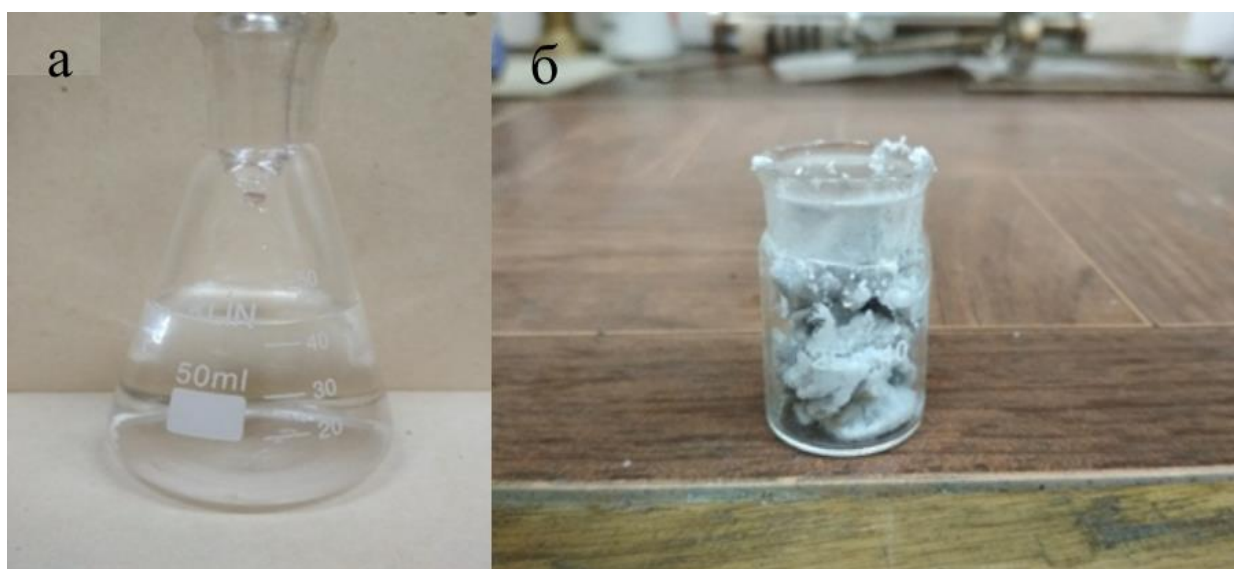
Рисунок А2-продукты, полученные в ходе ПФТ: а) жидкие б) твердые
