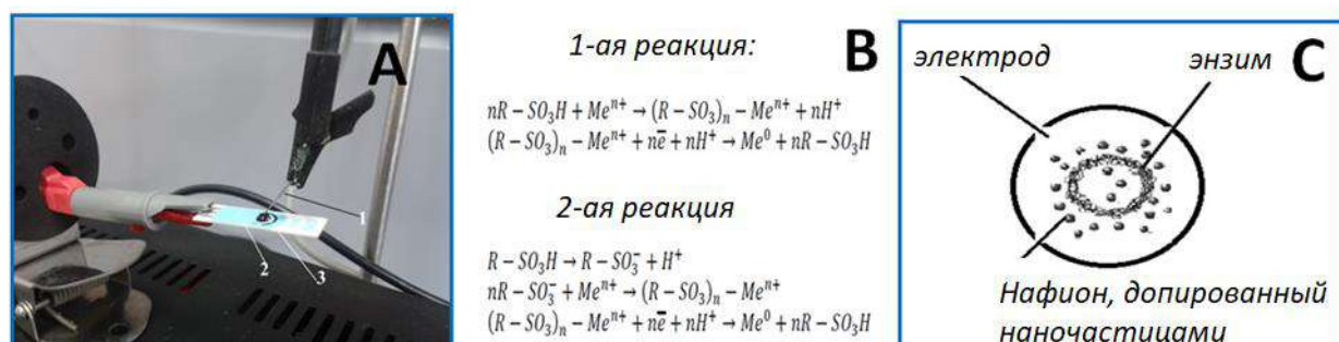
Рис. 2.2 – Экспериментальная установка одностадийного соосаждения гибридной функциональной пленки в капле. А: 1 – электрод/проволока; 2 – трафаретный электрод, SPE; 3 – 10 мкл раствора смешанного электролита и
