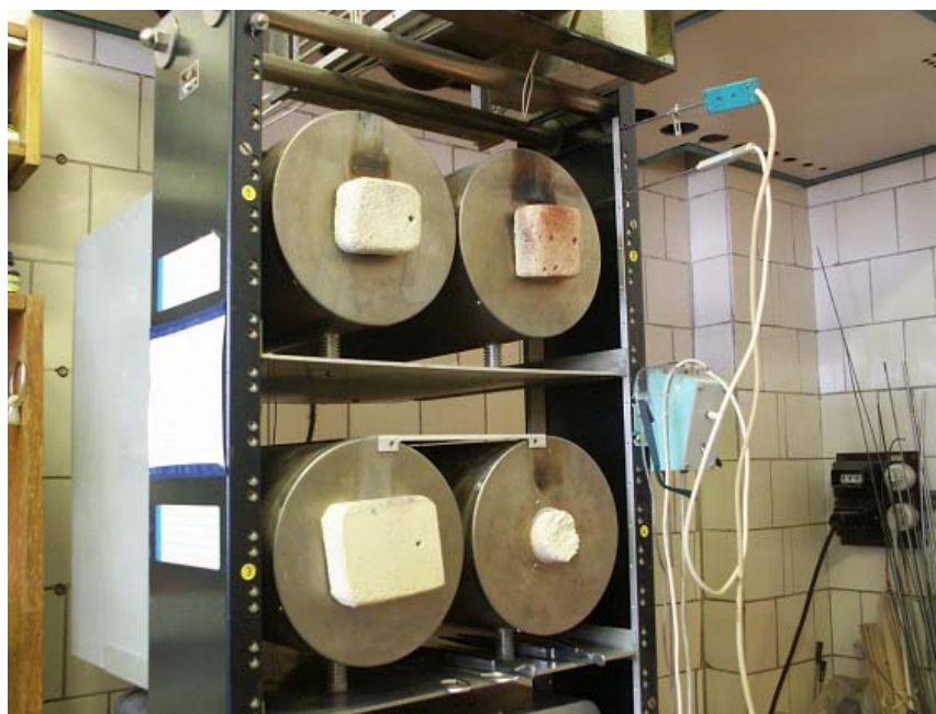
Рисунок 10 – Печи для синтеза веществ
