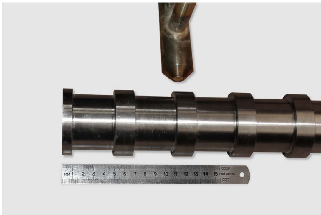
Рисунок 54 - Взаимное расположение волноводной системы с прямоугольными выступами и датчика динамического давления ПС 01-03 в ходе эксперимента
