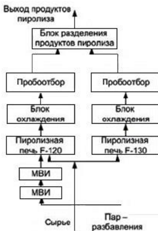
Рисунок 1.8. - Схема подключения двух микроволновых аппаратов в технологическую линию пиролиза углеводородного сырья
