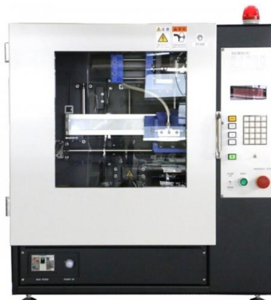
Рис.2.3. Коммерческая лабораторная установка для электроформования Nanon – 01A (MECC Co. LDT Япония).
