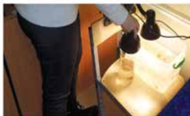
Рис. 3. Проведение процесса фото-Фентона (под видимым светом) для очистки проб воды из р. Ликова объёмом 0,5 л (A) и 5 л (B)
